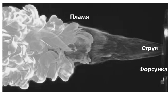
Рис. 2 Кадры видеосъемки факельного горения струи ПГ-2 в воздухе в последовательные моменты времени (сверху вниз)
