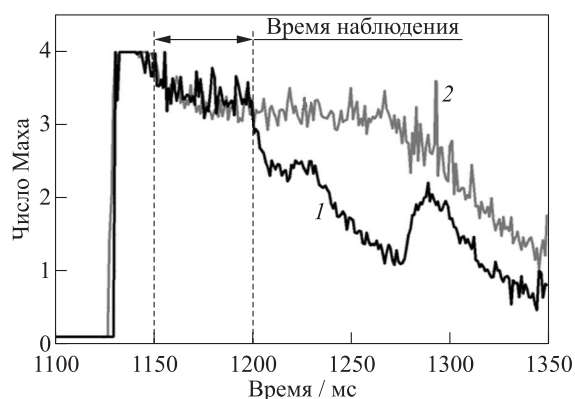
Рис. 5 Расчетные зависимости местного числа Маха на входе в ВЗУ модели ДПВРД от времени в огневом испытании (1) и при холодной продувке (2)
