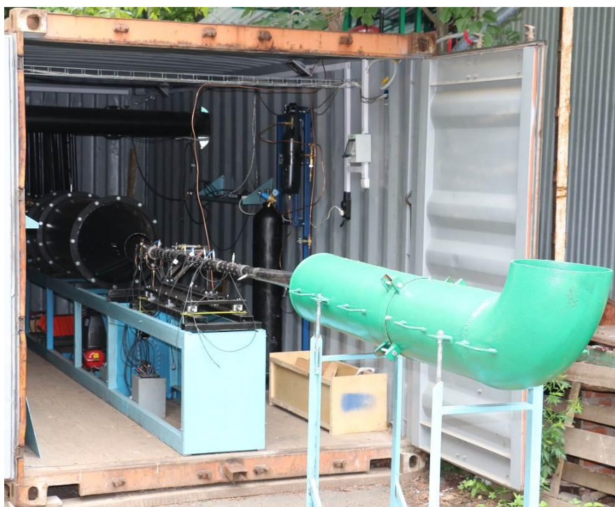
Рис.3 – Фотография экспериментального стенда с установленным на тяговом столе модулем со снятым кожухом-обтекателем и с акустическим поглотителем.
