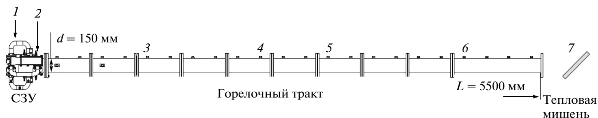
Рис. 1. Схема опытного образца ГИДС и точки установки термопар (см. текст).
