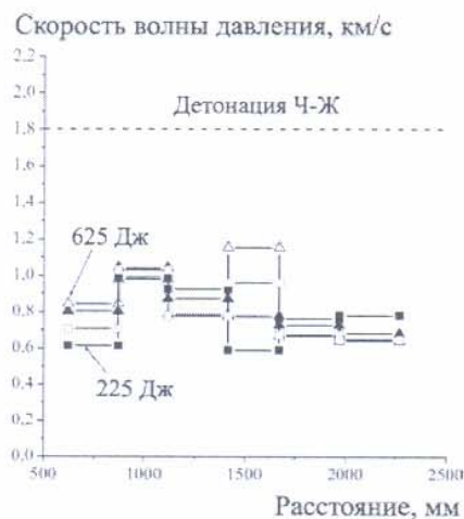
Рис. 1. Изменение скорости волны давления в потоке керосино-воздушной смеси в четырех опытах в прямой детонационной трубе при энергии зажигания от 225 до 625 Дж
